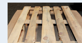
Nadopusten konstrukcijski del, n.pr. premajhna dimenzija, trhlost, lisičavi rob
