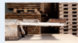
Manjkajoči konstrukcijski del
